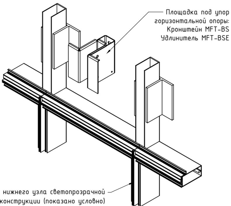
Элементы нижнего узла светопрозрачной конструкции (показано условно)
