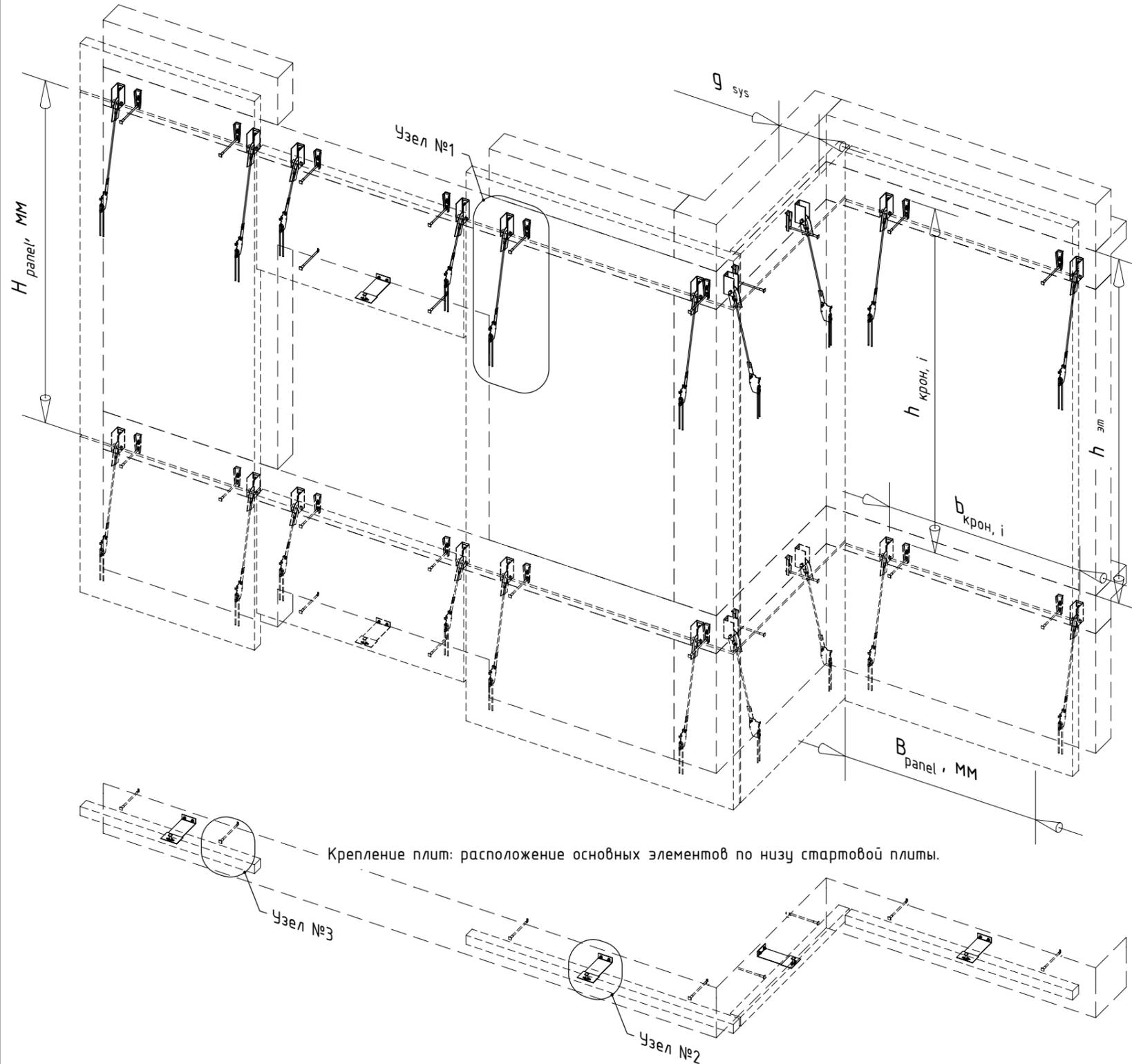
Крепление плит: расположение основных элементов по низу стартовой плиты.
