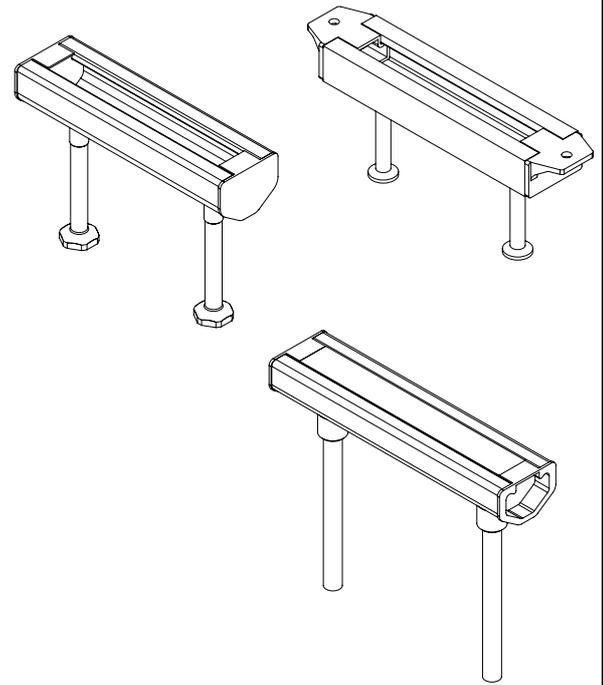
крепление кронштейна НВФ или СПК к строительному основанию, элемент закладывается в толщу строительного основания, внешний вид показан условно
