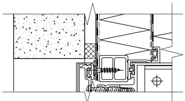
Фрагмент №1: вариант выполнения откоса без упора горизонтальной опоры.
