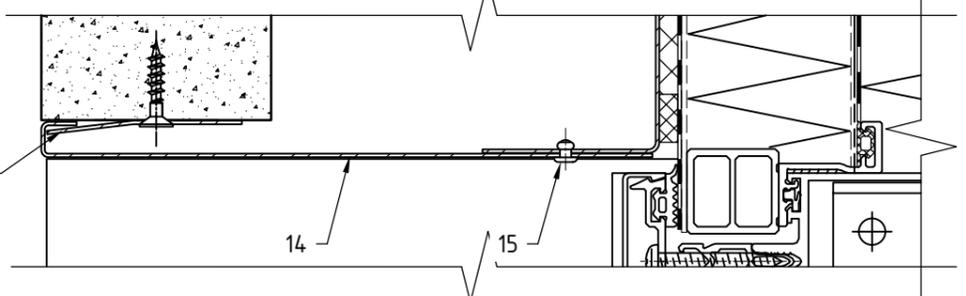
Примыкание к верхнему откосу: для витража вынесенного в толщу утеплителя относительно проема, стандартный противопожарный короб (ППК) с минимальным выступом/вылетом относительно внешней плоскости облицовки с минимальной высотой/шириной видимой выступающей части.
