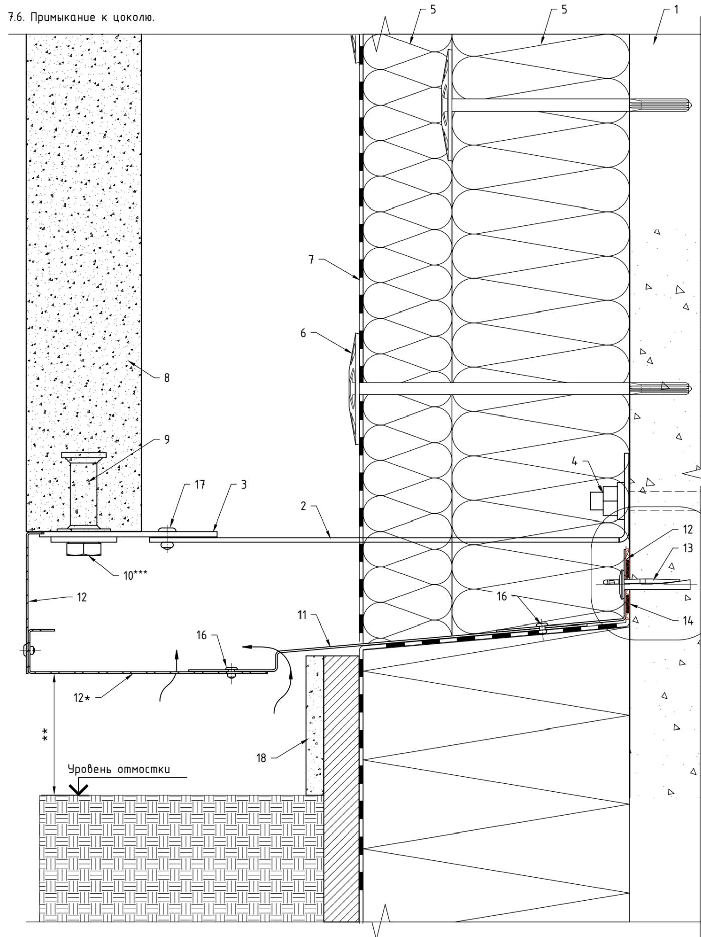
Фрагмент №1: доп. вариант крепления отлива к строительному основанию.
