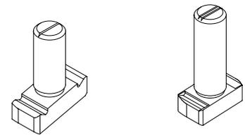
крепление кронштейна НВФ или СПК к строительному основанию через анкерный канал, внешний вид показан условно, дополнительно к болту требуется шайба и самоконтрящаяся гайка
