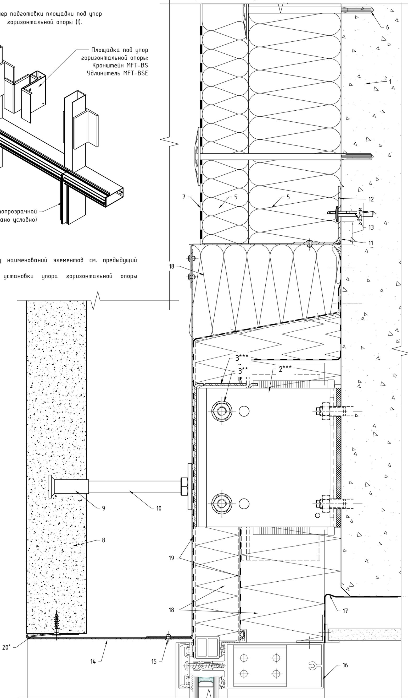
Примыкание к верхнему откосу: для витража вынесенного в толщу утеплителя относительно проема, скрытый противопожарный короб (ППК) откос выполнен в составе плиты облицовки (формовка плит выполняется совместно с откосами, общее армирование откоса и лицевой части облицовки).
