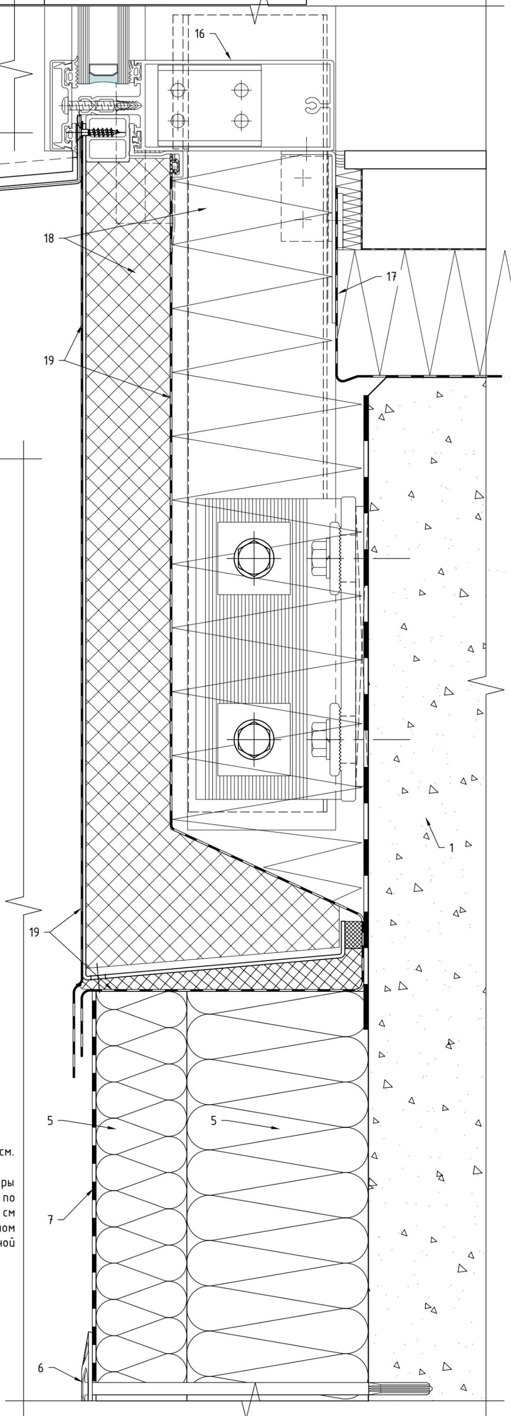
Примыкание к отливу: для оконного (дверного) блока установленного в проем, стандартный отлив из металлического листа.
