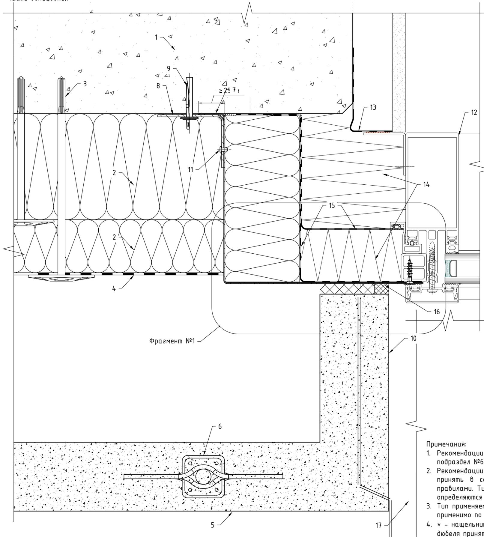
Фрагмент №1: доп.вариант примыкания откоса из арх.бетона к СПК.
