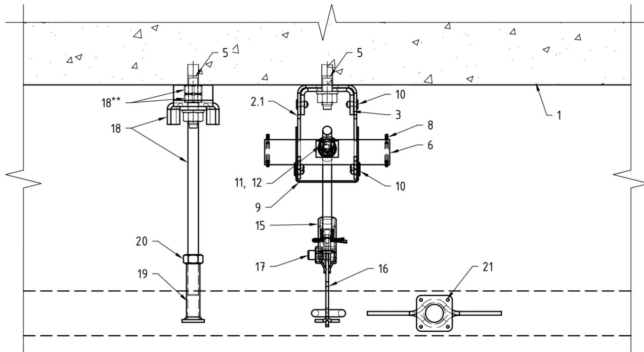
Вариант крепления с петлей-коннектором, исполнение кронштейна №2.
