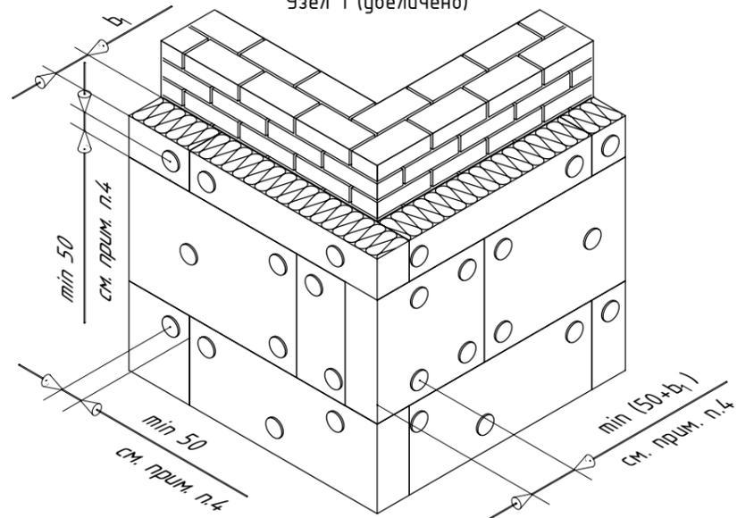
Схема установки термовкладыша (утеплителя) в верху проема в пожароопасных зонах
