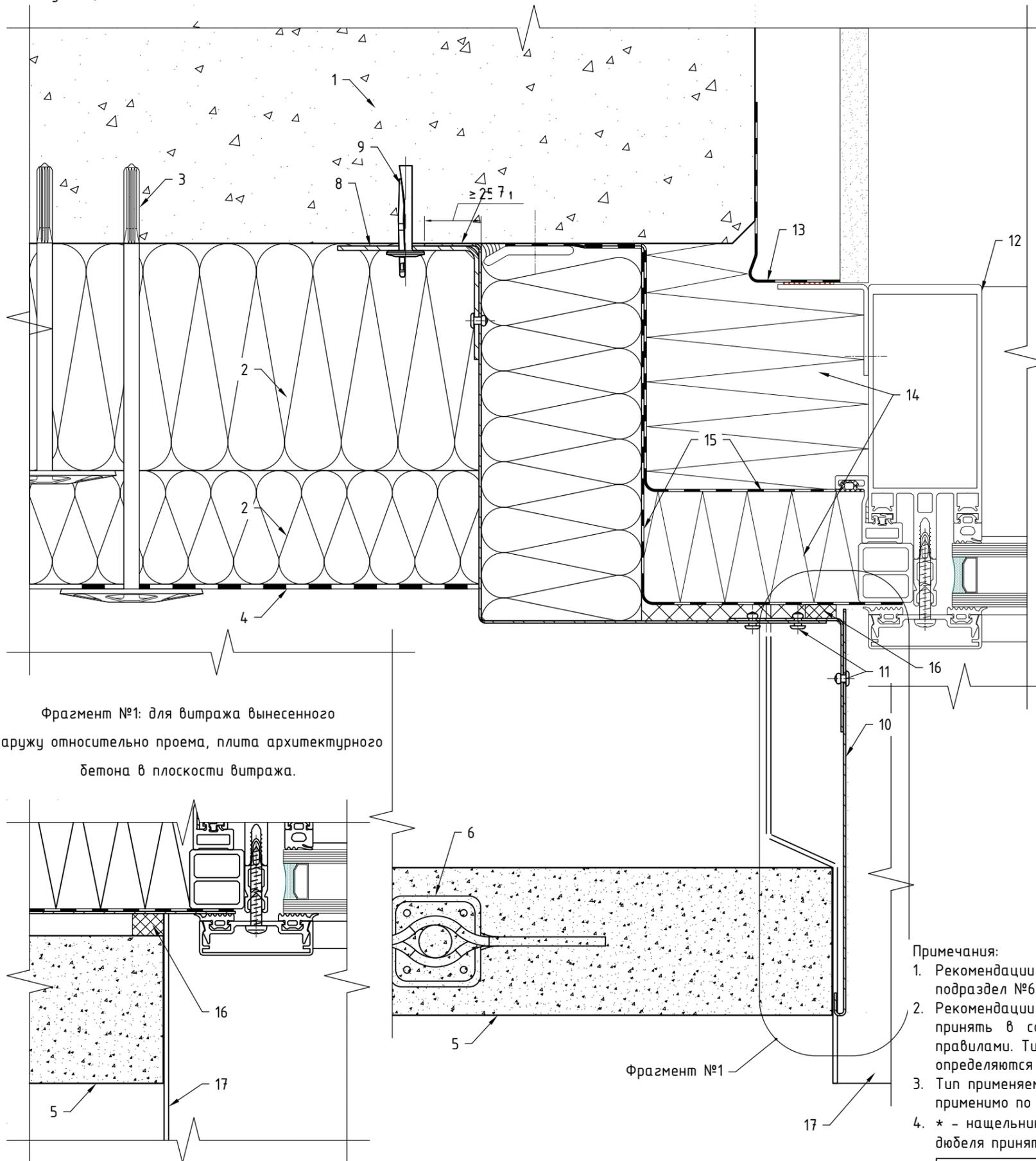
Фрагмент №1: для витража вынесенного наружу относительно проема, плита архитектурного бетона в плоскости витража.
